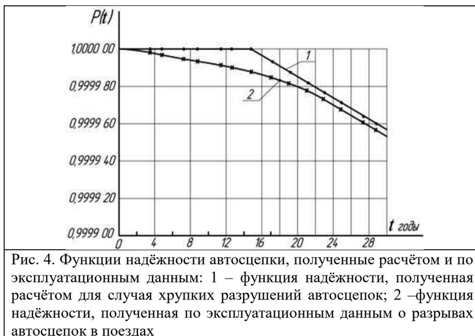
На основе указанного метода расчета дана оценка степени опасности внутренних дефектов в литых деталях подвижного состава железных дорог, перерастающих в усталостную трещину. С использованием этого решения получены численные результаты по оценке недопустимых без исправления размеров внутренних литейных дефектов типа усадочных раковин в переходной зоне автосцепки – типичной литой вагонной детали.
