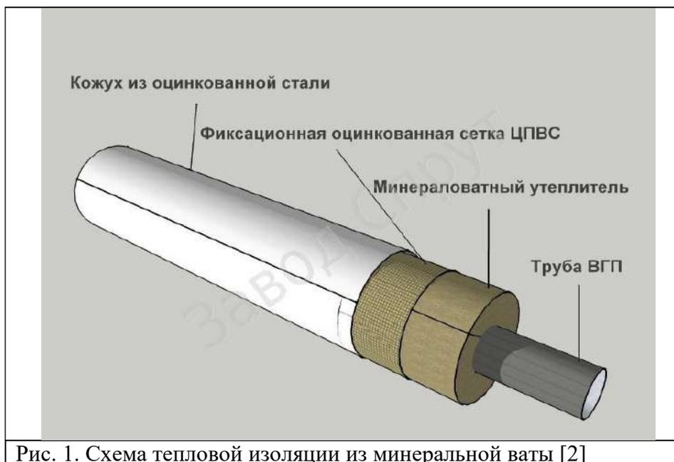
Рис. 1. Схема тепловой изоляции из минеральной ваты [2]
