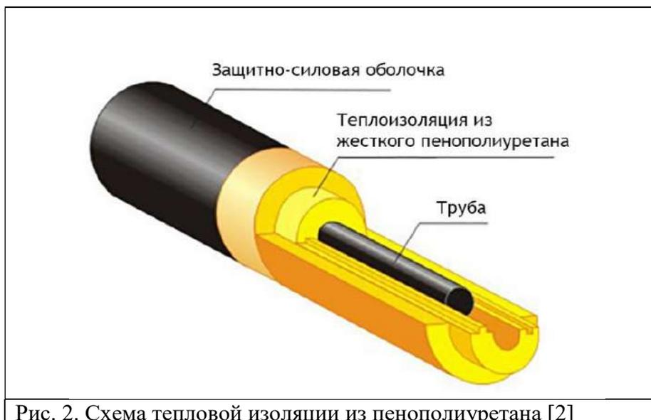
Рис. 2. Схема тепловой изоляции из пенополиуретана [2]
