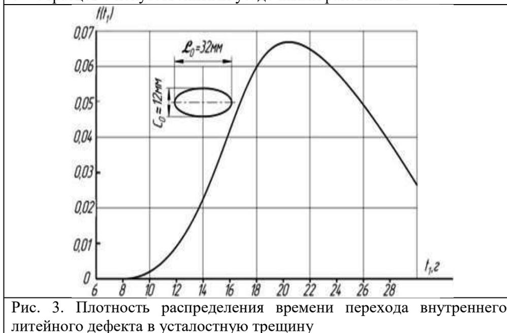
Рис. 3. Плотность распределения времени перехода внутреннего литейного дефекта в усталостную трещину
