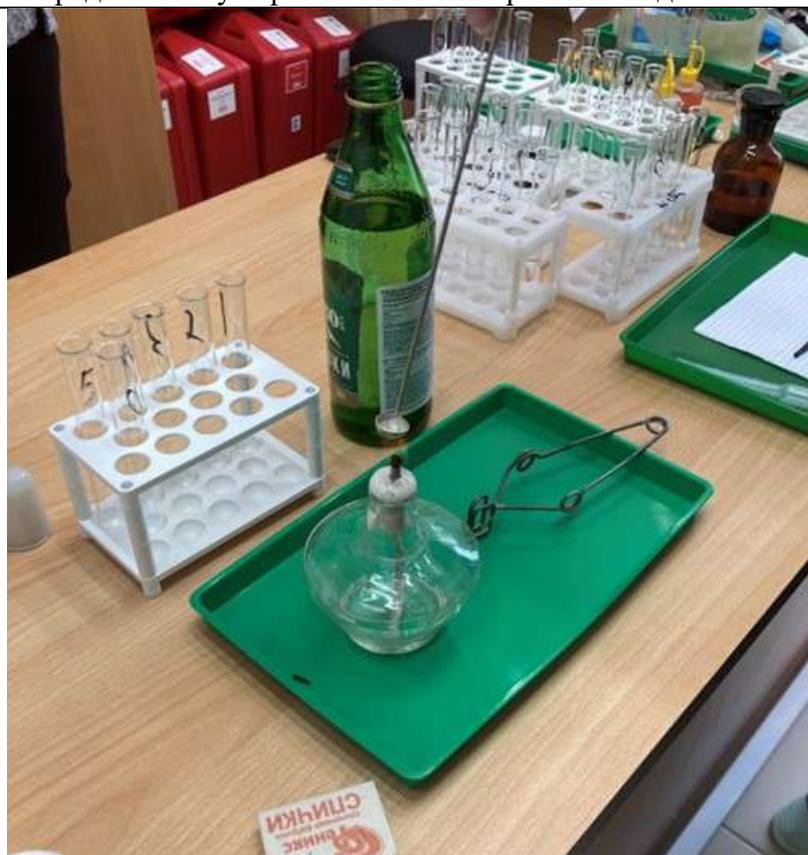
Рис. 3. Определение наличия катионов щелочных металлов в воде
