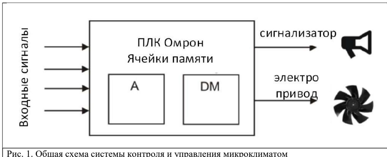
Рис. 1. Общая схема системы контроля и управления микроклиматом
