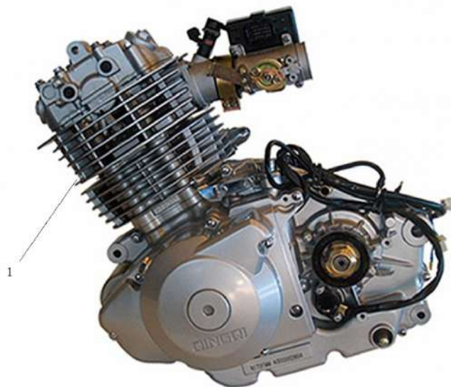
Рис. 12. Двигатель мотоцикла с воздушной системой охлаждения естественным способом: цилиндр с рёбрами охлаждения
