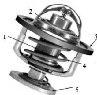
Рис. 8. Термостат: 1 – цилиндр с воском; 2 – основной клапан; 3 – корпус; 4 – пружина; 5 – клапан малого круга
