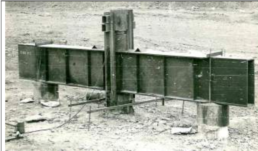
Рис. 4. Испытания свай выдёргивающей нагрузкой
