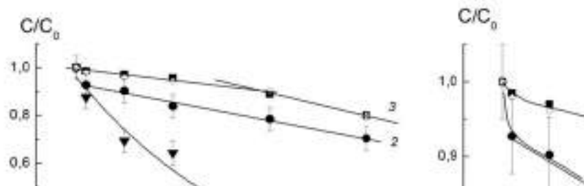
Рис. 4. Кинетика восстановления водных растворов \text{KMnO}_4 при воздействии ДБР. Концентрация 5 (1), 20 (2), 50 и 80 (3) мг/л, ток разряда 0,25 мА. (б) увеличенный масштаб по оси ординат (относительной концентрации)
