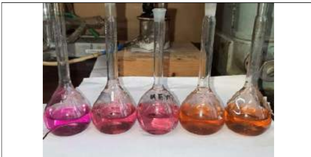
Рис. 2. Растворы перманганата калия через 1, 5, 10, 20, 30 минут обработки в реакторе ДБР. Ток разряда 0,25 мА, концентрация 5 мг/л
