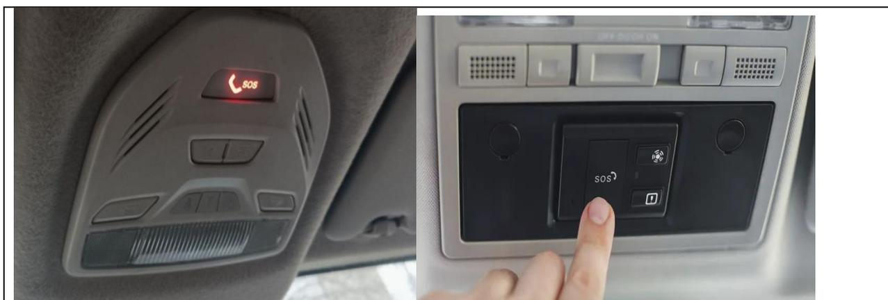
Рис 6. Кнопка вызова экстренных оперативных служб ЭРА-ГЛОНАСС, установленная на автомобиле
