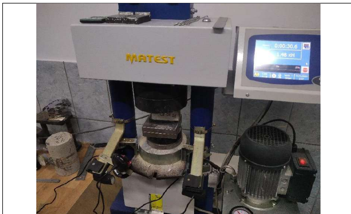
Рис. 1. Испытание половинки призмы на сжатие в горизонтальном положении (разработано автором)
