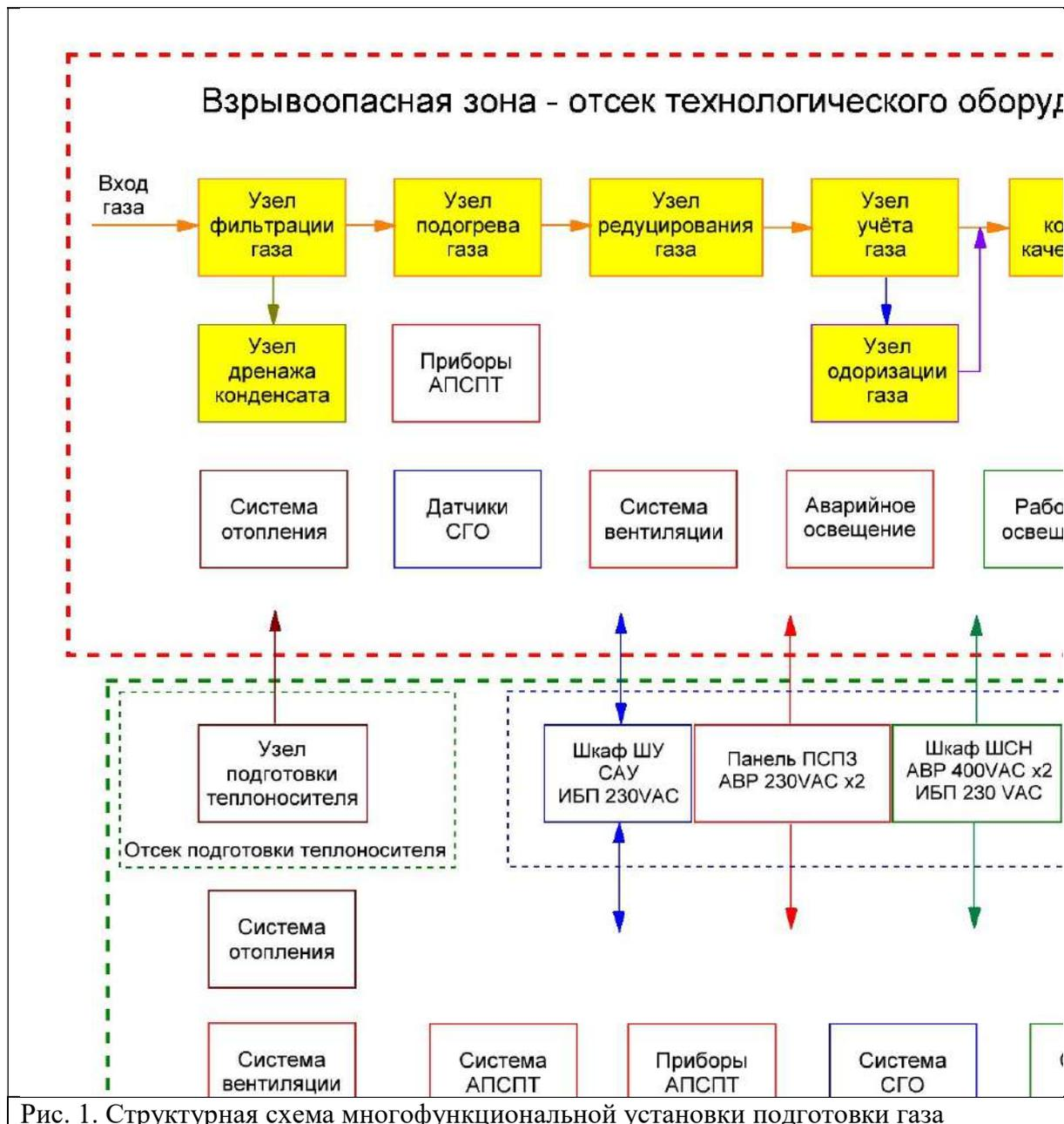
Рис. 1. Структурная схема многофункциональной установки подготовки газа
