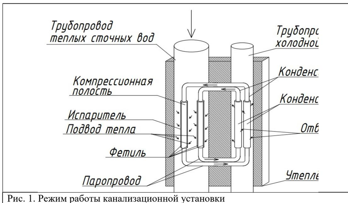
Достоинством такой данной модели является: высокий уровень теплопередачи, простота конструкции, надежность в работе, хорошая степень адаптации к различным условиям, сохранение рабочих характеристик. На рисунке 2 представлена автоматизация канализационной установки со всеми необходимыми датчиками и запорной арматурой.
