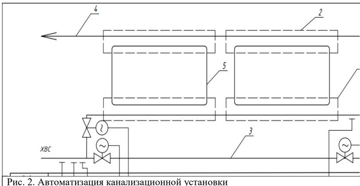
Таким образом, предложенная авторами канализационная установка с тепловыми трубками замкнутого контура позволяет снизить затраты электроэнергии или газа для индивидуальной системы горячее водоснабжение за счет повышения температуры холодной вод, где срок окупаемость составляет 5,9 лет при общей эксплуатации 25 лет. А также обеспечить автоматическое управления режимами работы системы для повышения энергоэффективности в зависимости от температуры сточных вод.
