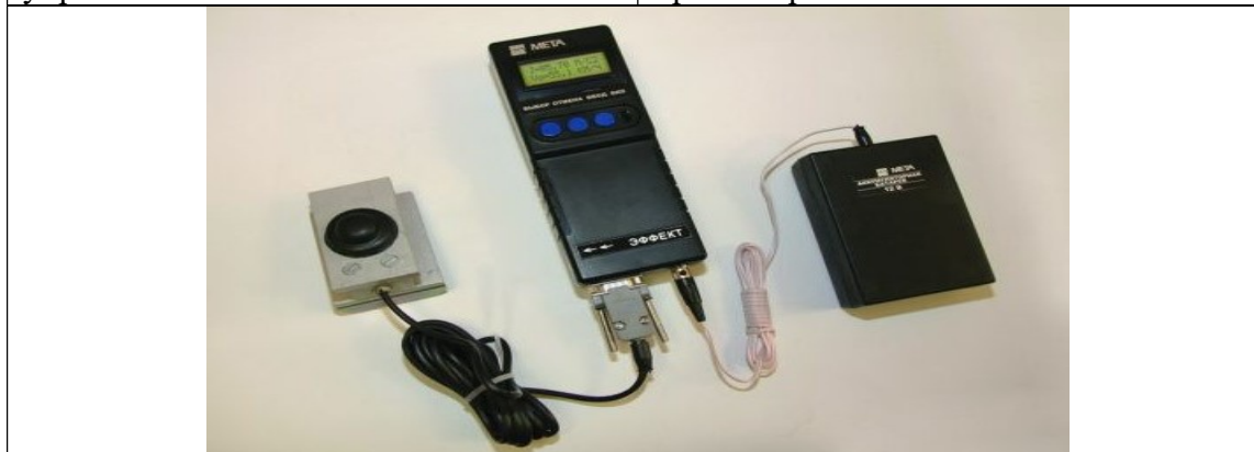
Рис. 4 Прибор для проверки эффективности тормозных систем ЭФФЕКТ-02
