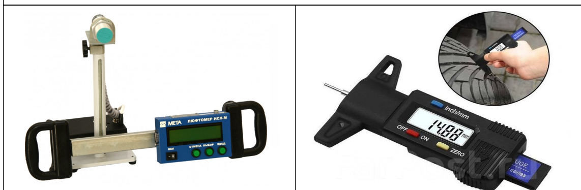
Рис. 2 Прибор для проверки суммарного люфта рулевого управления ИСЛ-М
