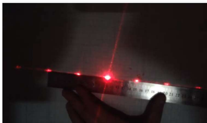
Рис.4. Измерение расстояний между порядками первого, второго и третьего максимума дифракционной решетки
