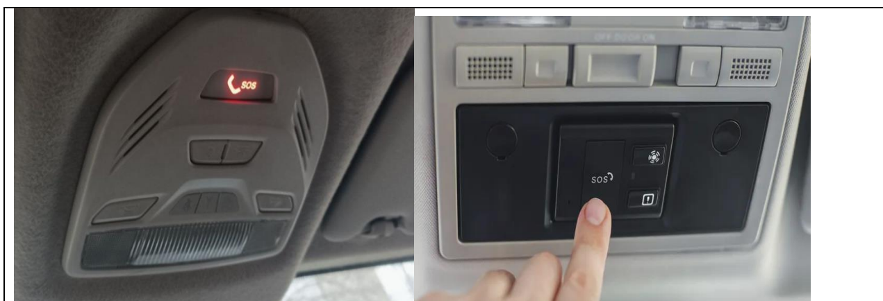
Рис 6. Кнопка вызова экстренных оперативных служб ЭРА-ГЛОНАСС, установленная на автомобиле
