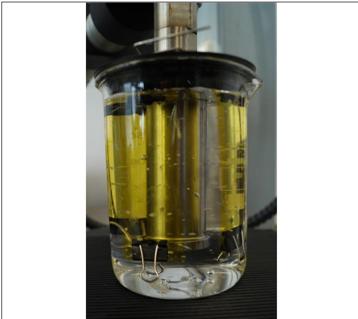
Рис. 1. Фотография процесса воздействия ультразвуком с частотой 20 кГц на полиимидные пленки в растворе
