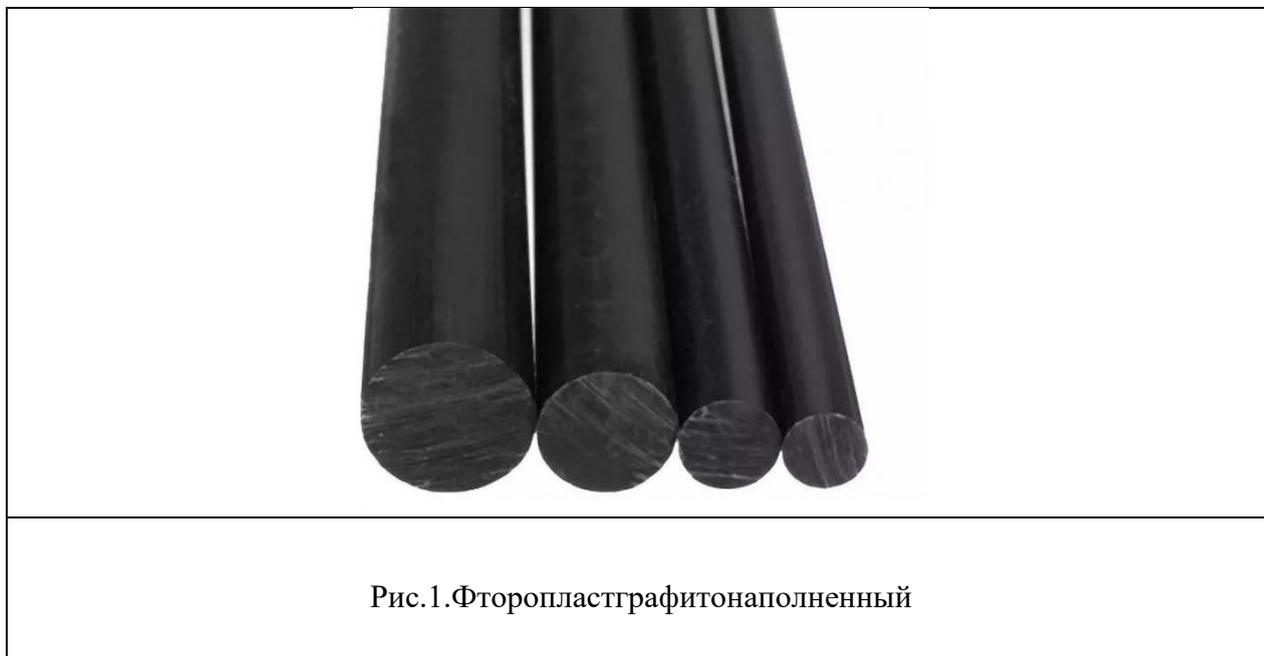
Графитонаполненный фторопласт – это термостойкий полимер, который выдерживает экстремальные температуры и химические воздействия. Его уникальные свойства открывают новые горизонты в самых разных областях промышленности. Этот материал обладает высокой электрической изоляцией, устойчивостью к коррозии и способностью выдерживать высокие температуры без потери своих качеств. Такие характеристики делают его идеальным кандидатом для использования в жидкометаллических предохранителях [2].
