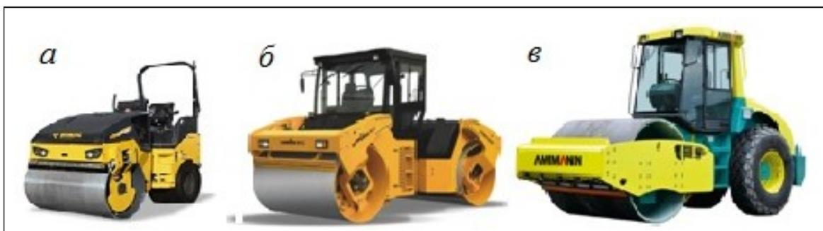
Рис. 3. Катки по массе машины: а) легкие; б) средние; в) тяжёлые
