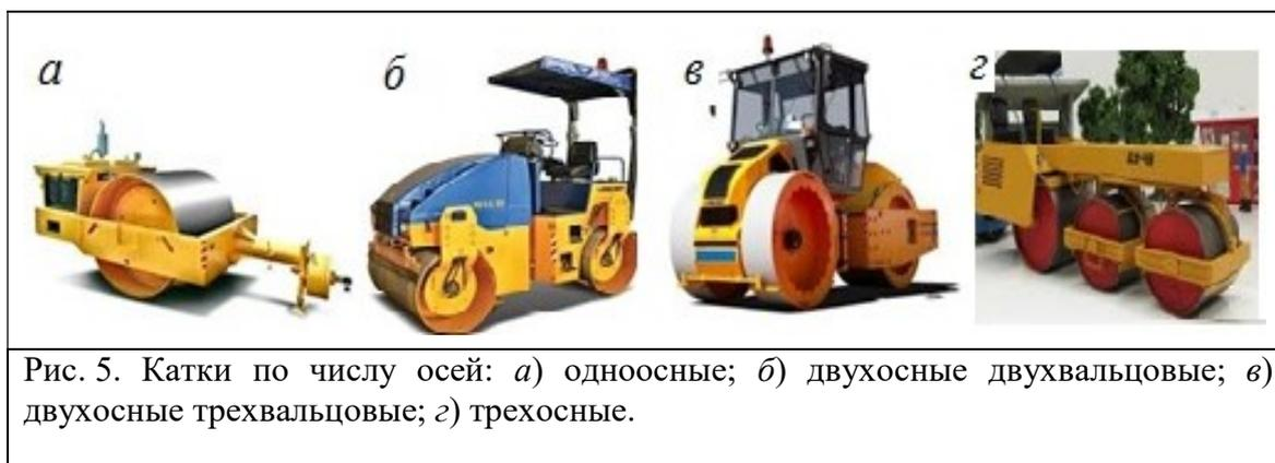
Рис. 5. Катки по числу осей: а) одноосные; б) двухосные двухвальцовые; в) двухосные трёхвальцовые; г) трёхосные.
