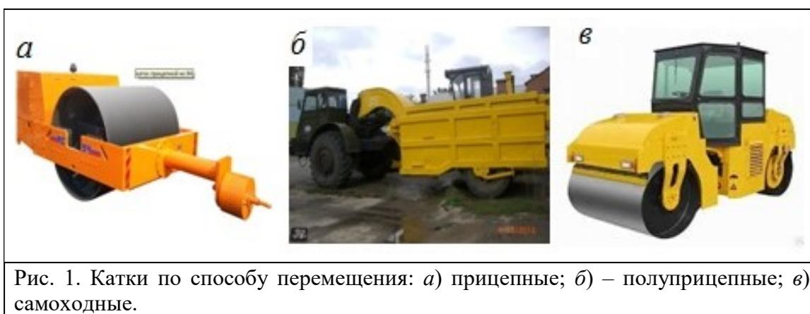
Рис. 1. Катки по способу перемещения: а) прицепные; б) – полуприцепные; в) самоходные.
