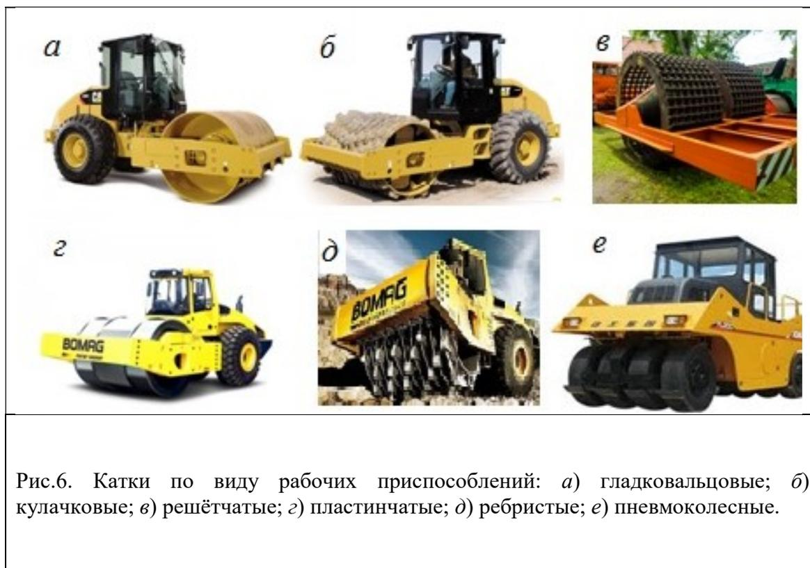
Рис.6. Катки по виду рабочих приспособлений: а) гладковальцовые; б) кулачковые; в) решётчатые; г) пластинчатые; д) ребристые; е) пневмоколесные.
