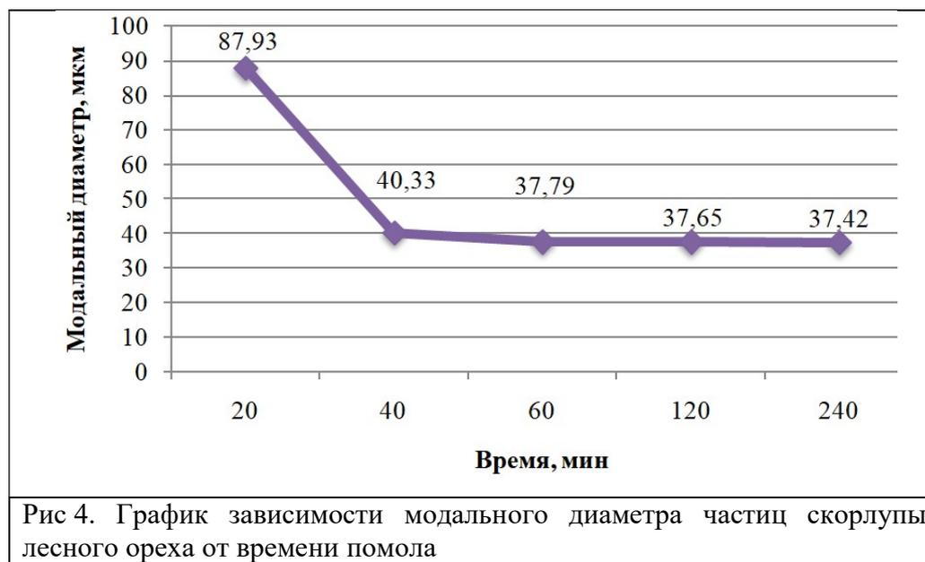
Рис 4. График зависимости модального диаметра частиц скорлупы лесного ореха от времени помола
