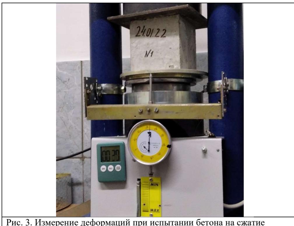
Рис. 3. Измерение деформаций при испытании бетона на сжатие
